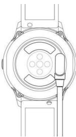
\*Napunite sat samo na prikazani način. Nepravilno punjenje može oštetiti sat.
