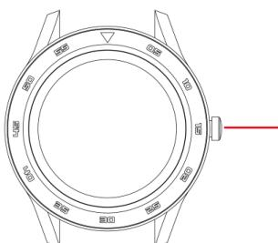
Бочно дугме: дугим притиском за укључивање / искључивање, кратким притиском за повратак на интерфејс часовника. Уређај се може тешко ресетовати дугим притискањем 10 секунди.
