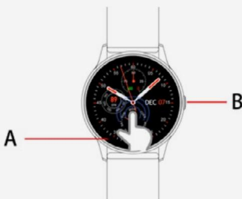
Vaš sat se kontroliše pomoću ekrana osetljivog na dodir „A“ i tastera za pritiskanje „B“, koji je taster za povratak. Pritisnite i držite dugme pritiskača za uključivanje / isključivanje napajanja.
